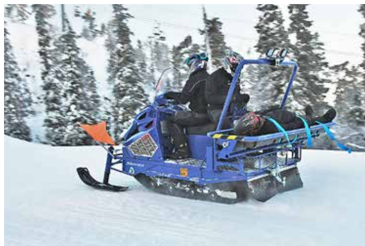
↑ Paariteline on lisävaruste, jonka avulla loukkaantunut henkilö saadaan tuotua nopeasti maastosta. Teline pyrkii pitämään itsensä koko ajan suorassa, riippumatta rinteen jyrkkyydestä.
