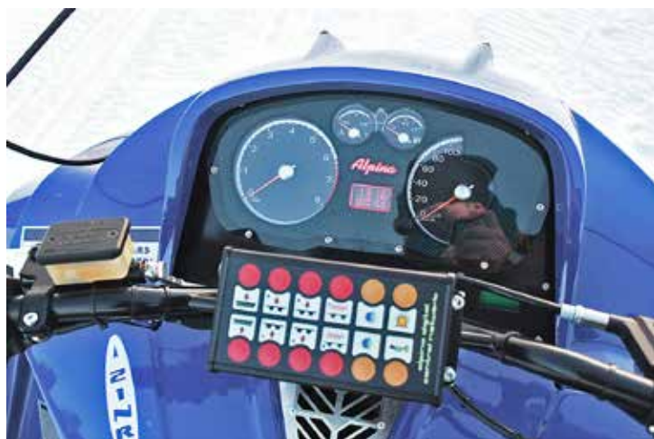
↑ Mittaristo on monipuolinen, ohjaustangossa on kiinnitettynä latukoneen ohjauslaite.
