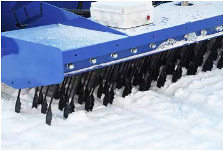
↑ Latukoneen murskain on tehty noukkimen piikeistä ja osoittautui yllättävän tehokkaaksi.
