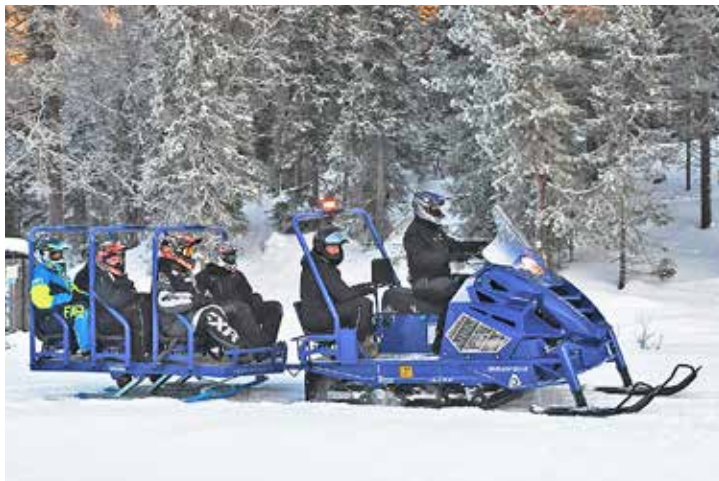
↑ Henkilökuljetusrekeen mahtuu kerralla 9 henkilöä ja istuimet poistamalla se muuttuu nopeasti tavarankuljetulavetiksi.
